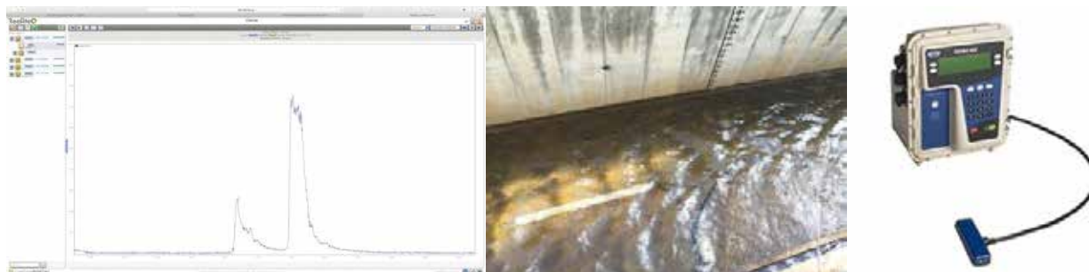
איור 9: מימין, מד הספיקה עם יחידת הסנסור. במרכז, התקנת ציוד הניטור/דיגום בתחתית התעלה. משמאל, דוגמה הידרוגרף של אירוע נגר בתחנה G 23.2.16 כפי שנצפה באתר האינטרנט צילומים: יח"צ ועדי האפט
