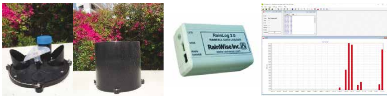
איור 12: משמאל, מד הגשם ותוכנו, במרכז, אוגר נתוני הגשם Data logger, מימין, תצוגה גרפית של כמות המשקעים במ"מ צילומים: עדי האפט
