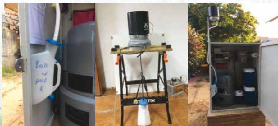
איור 13: משמאל, מיכל איסוף מי הגשם, במרכז, מתקן ייעודי לאיסוף מי הגשם, מימין, ארון הדיגום עם מד הגשם המוגבה וצינור מי הגשם היוצא ממנו אל מיכל האיסוף הממוקם בתוך הארון צילומים: עדי האפט
