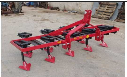
קלטרת קפיצים 9 רגליים עם כפות מסוג כף אווז (להבי עיבוד בצורת כפות אווז וכנפיות המשמשים לחיתוך שורשים).
